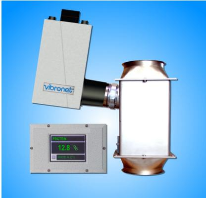
Die **VIB-PROTEIN<sup>®</sup>** ist ein auf NIR (Nah-Infrarot Lichtabsorption) basierendes Mess-System, das kontinuierlich und berührungslos online Protein und Feuchtigkeitsgehalt von Körnern, Hülsenfrüchten und pulverförmigen Produkten bestimmt. Das System wird in den unterschiedlichsten industriellen Prozessen eingesetzt und bietet offline Genauigkeit unter online Betriebsbedingungen.
