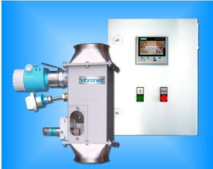
Die VIB-SMC<sup>®</sup> ist ein kompaktes, robuste kontinuierliches Kontrollsystem zur Bestimmung der Oberflächenfeuchte von gravimetrisch transportierten frei fließenden körnigen Schüttgütern wie Körner, Hülsenfrüchte und Granulate direkt vor dem ersten Verarbeitungsprozess. Es ersetzt veraltete manuelle Methoden wie das Zerbeißen oder Befühlen von Körnern durch automatische Online-Kontrolle.
