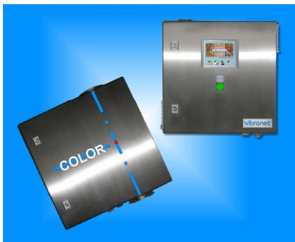
**VIB-CC<sup>®</sup> ist ein einfaches und schnelles Werkzeug zur kontinuierlichen Kontrolle des Kontrastwert (Helligkeit / Asche) von Mehl, Grieß, Dunst, Feinkleie, und Pulver. Das System arbeitet nach dem Prinzip des visuellen Vergleichs der Pekar-Methode. Farb- und damit Qualitätsabweichungen in der Produktion werden sofort angezeigt und ermöglichen eine schnelle Anpassung für optimale Endprodukte.**
