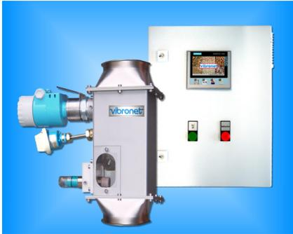
**VIB-SMC<sup>®</sup>** est un système de contrôle en continu compact et robuste de déterminer l'humidité de surface des matériaux granulaires à écoulement libre transporté par gravimétrie tel que par ex. céréales (froment, seigle, riz, maïs, etc.) directement avant la production. Il remplace les méthodes manuelles d'autrefois tels que mordre et toucher le grain avec un contrôle automatique en ligne.
